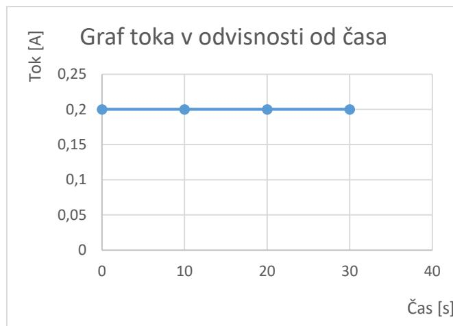
6. Odčitaj tok na spodnjih slikah in izračunaj, koliko naboja se pretoči skozi posamezni ampermeter v 35 minutah.
